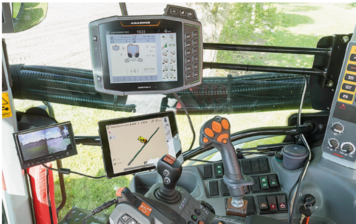
Vollausstattung mit Amatron 4, iPad und Multifunktionsgriff „AmaPilot+“. Links unten der Bildschirm für die Seitenkameras am Fronttank...
