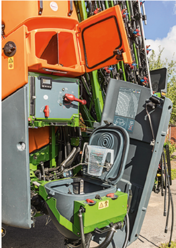
Vollausstattung mit Amatron 4, iPad und Multifunktionsgriff „AmaPilot+“. Links unten der Bildschirm für die Seitenkameras am Fronttank...
