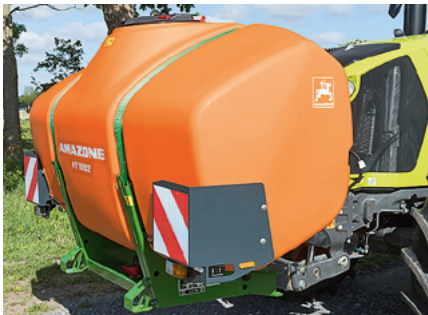
...der jetzt stolze 1500 l fasst und auf Wunsch komplett in das System integriert ist.
