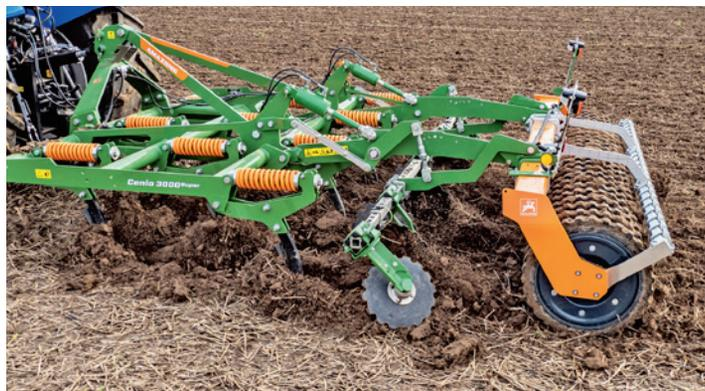
Der 3-Punkt-Grubber wird in starrer Ausführung als Super-Variante mit Druckfeder-Überlastsicherung...
