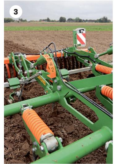
Der Zustreicher trägt nur unwesentlich zum Maschinengewicht bei, ist leichtzügig und wirkt sich so positiv auf den Kraftstoffverbrauch aus. Weitere Pluspunkte dieser Variante sind die schnelle Anpassung der Randlelemente für den Ackereinsatz und die Straßenfahrt sowie die integrierte Überlastsicherung.
