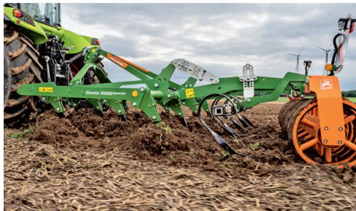
... und als Special-Variante mit Scherbolzen-Überlastsicherung angeboten.
