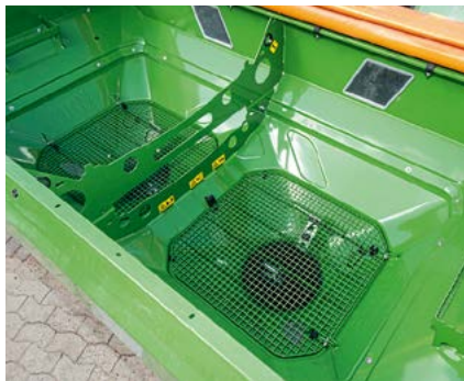
Die Roste sind sehr stabil und sogar mit einer Arretierung versehen, damit sie beim Reinigen nicht ungewollt abklappen.
