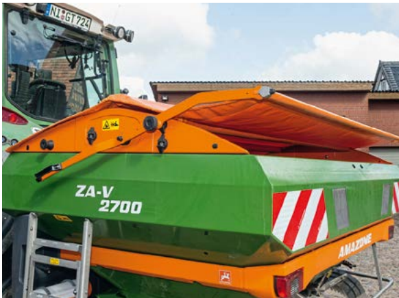
Die Plane hat uns sehr gut gefallen, vor allem auch die Position zum Waschen und Trocknen. Eine Tankbeleuchtung fehlt leider. Der auf beiden Seiten angebrachte klappbare Aufstieg hat stabile und sichere Tritte.
