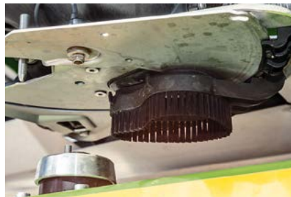
Die Trichterausläufe sind schön glatt und laufen spitz zu. Das Rührwerk arbeitet schonend. Die Bürsten am Auslauf verhindern springende Körner.
