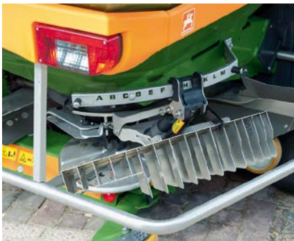
Der neue Limiter V+ schwenkt elektrisch von oben in den Düngerfächer. Es gibt ihn ausstattungsabhängig links, rechts oder beidseitig.
