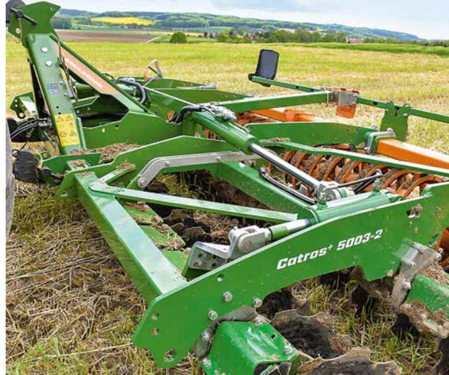
△ Ein Gestänge verbindet die beiden Scheibenreihen miteinander. Die Arbeitstiefe lässt sich unabhängig vom Nachläufer einstellen.
