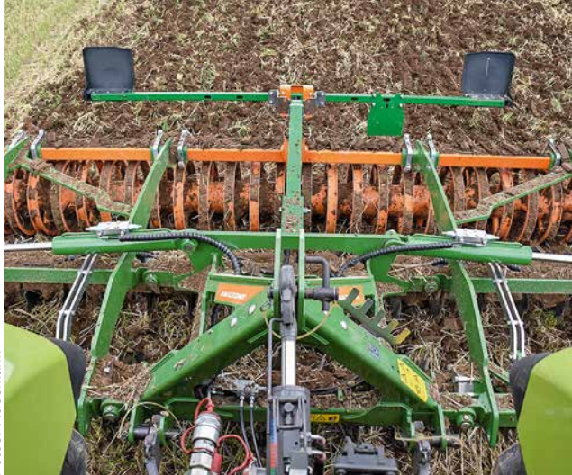
△ Die Scheibenegge Catros hat eine aufgeräumte Konstruktion. Auf dem Rahmen bleibt wenig Erde liegen.
