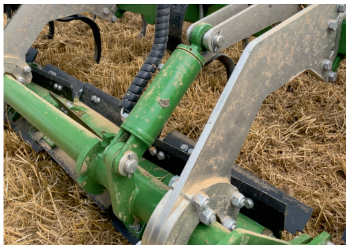
Per Hydraulik lässt sich die Arbeitsintensität der Messerwalze ändern. Wird sie nicht gebraucht, kann sie der Fahrer bequem ausschwenken.
