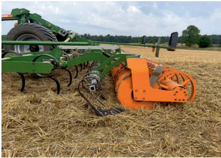
Dank der Parallelogrammführung bleibt der Bodenkontakt stets konstant - sehr gut.
