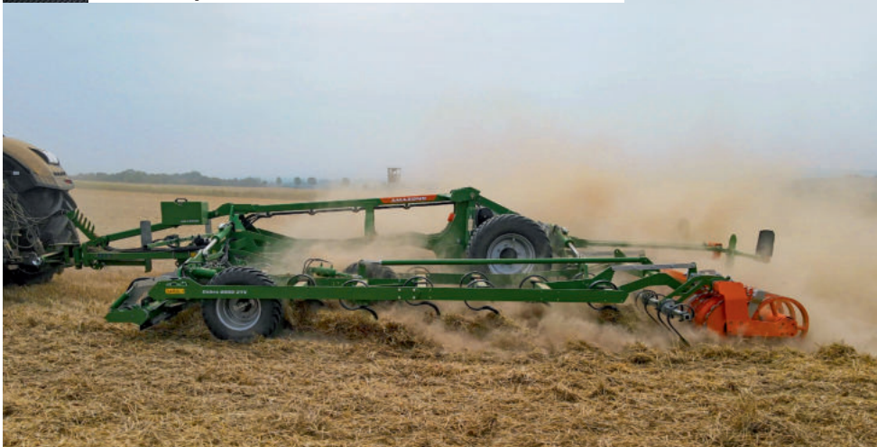
Die 45 Blattfederzinken teilen sich im Grunde auf 8 Balken auf. Der Balkenabstand misst zwischen 50 und 70 cm, die Rahmenhöhe 60 cm.
