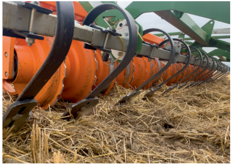
Direkt an der Walzeinheit sitzen die Einbuchtungspaddel, die sich gleich mit der Arbeitstiefe verstellen. Feinjustieren kann man sie dennoch.
