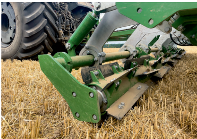
Amazone setzt bei der Messerwalze auf eine geschlossene Form. Die Wendemesser auf einem Walzenstück sind v-förmig angeordnet.
