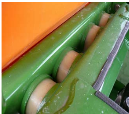
Abb.5: PU-Dämpfer der Deichsel.
