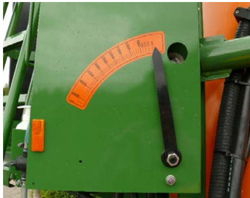
Abb.6: Füllstandsanzeiger für die Befüllung.
