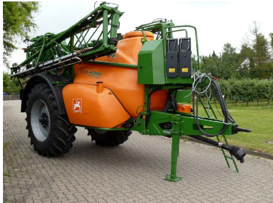
Abb.4:Geräteseite mit seitlich gefaltetem Gestänge.
