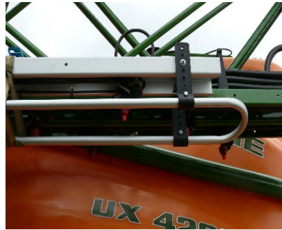
Abb.8: Düsenbügel an den äußeren Gestängesegmenten.
